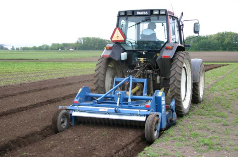
Fobro Kulti-Rotor 2000 fräser och lägger upp bäddar samtidigt. (Foto: RJ Maskiner)
