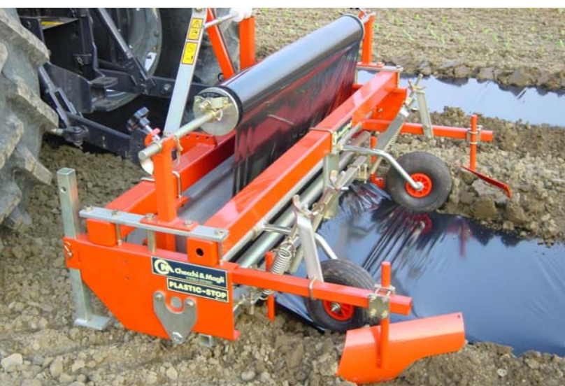
Plastic-Stop lägger ut plast på bäddar. (Foto: Checchi & Magli)
