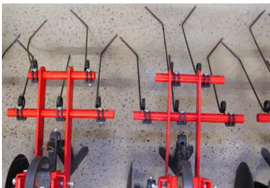
Efterharv och skrappinnar finns som tillbehör till Einböck radrensare (Foto: Bill Alsted).
