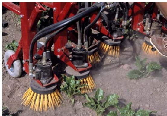
Borstar för ogräsbekämpning nära och i raden.
