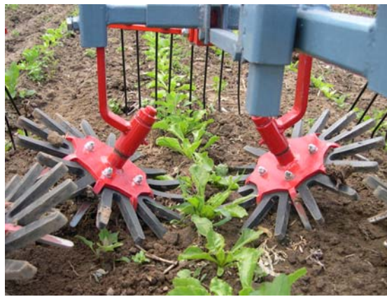
Fingerhjul från Steketee kan användas mot små ogräs i raderna när grödan är etablerad.
