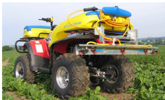
Sprututrustning på fyrhjulig terrängvagn. (Foto: Rødkilde ATV).
