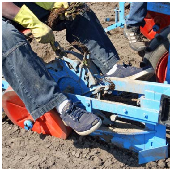
Super Prefer planteringsmaskin klarar både barrotsplantor och pluggplantor (Foto: RJ Maskiner)
