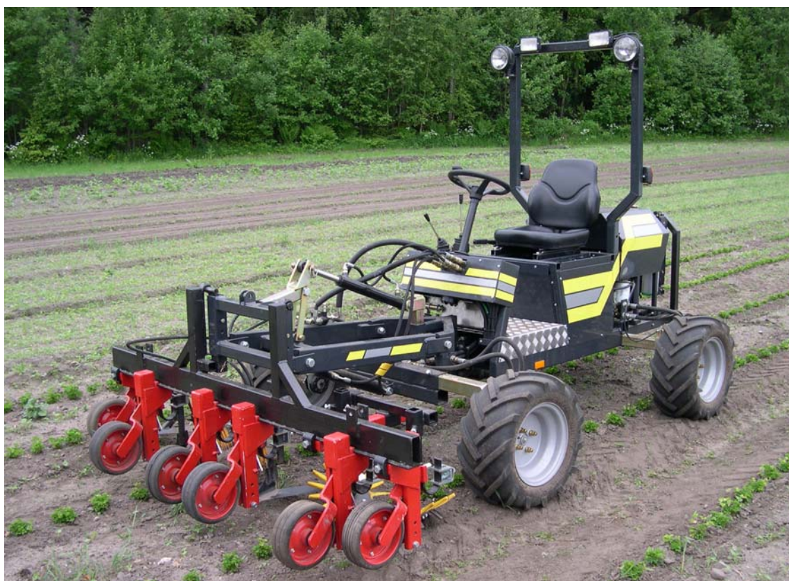
Mac Trac är en redskapsbärare som kan användas för olika arbetsuppgifter.
