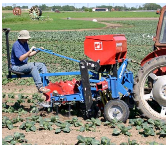
Radrensare av fabrikatet Hatzenbichler med gäsfotsskär, skyddstallrikar, efterharvar och gödselspridare. (Foto: RJ Maskiner)
