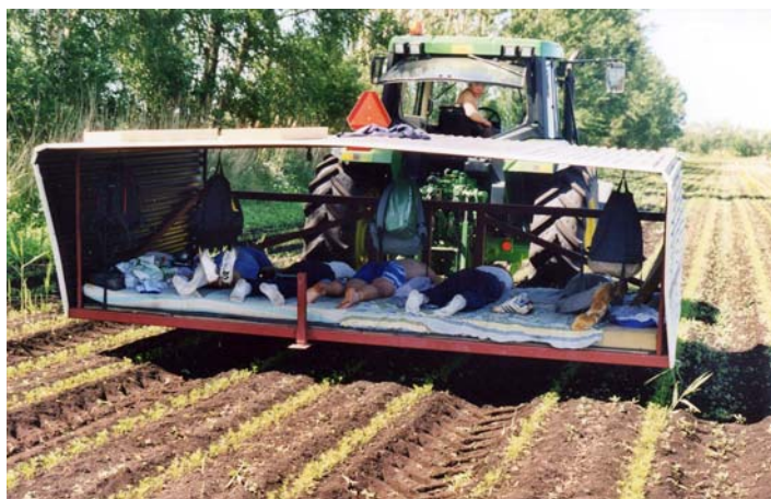
Ett exempel på en hemmabyggd vagn där fem personer ligger och rensar ogräs.
