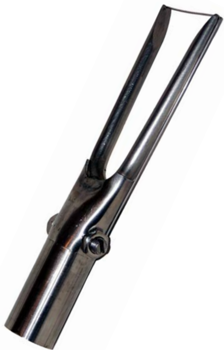
Precisionshackan består av en trådbygel och kan användas för ogräsrensning i raden och för gallring. (Foto: Finnhara)
