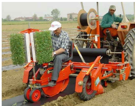
Wolf planteringsmaskin med roterande mataranordning. (Foto: Checchi & Magli)
