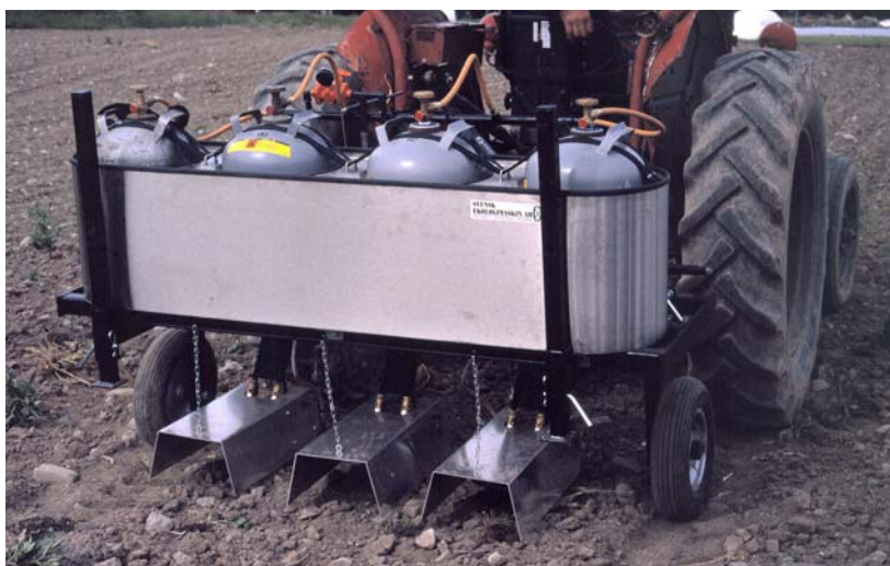
Thermec bandflammarer med gasolflaskor i ett uppvärmt vattenbad för att undvika isbildning på flaskorna.
