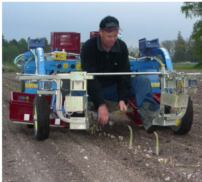
Bagioni Asp är en batteridrivna maskin för skörd av sparris. (Foto: Mia Jonson)
