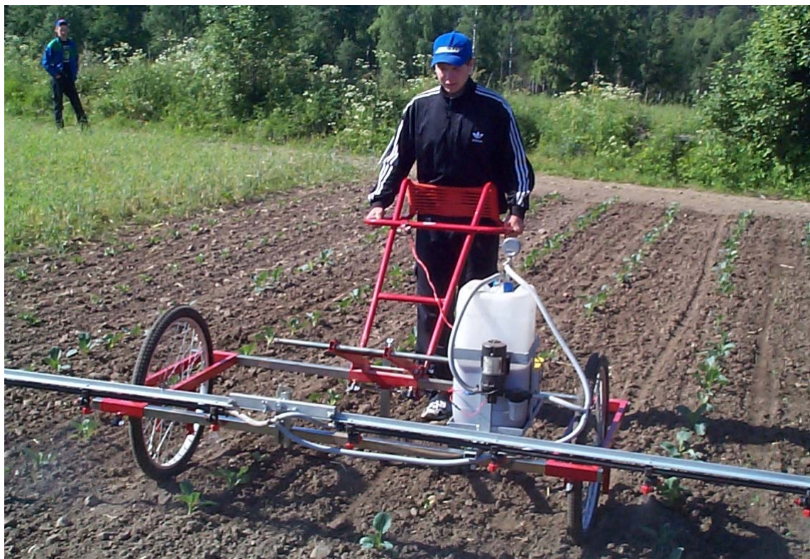
Redskapsbäraren Weed Master med sprututrustning. (Foto: Elomestari)
