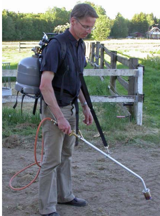
Thermec T100 med bärrem och handtag med stöd för underarmen. Gasolflaskan bärs i en ryggmes. (Foto: Svea Redskap)
