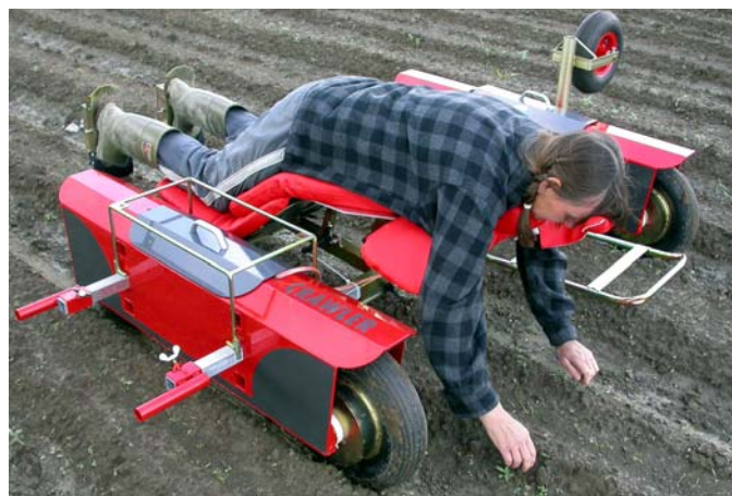
Crawler är en batteridrivna arbetsliggvagn från företaget Elomestari.
