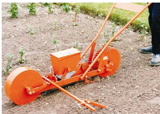
Såmaskinen Stanhay Robin 820 sår med hög precision. (Foto: Stanhay)
