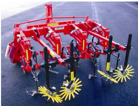
Fingerhjul från Kress för ogräsbekämpning i raderna monterade på en Einböck radrensare. (Foto: Bill Alsted).
